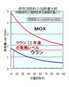
プルサーマルを実施すれば、使用済MOX燃料が生まれます。通常の使用済ウラン燃料の場合、乾式貯蔵のキャスクに移すためにはプールで約15年間冷却する必要があります。他方、使用済MOX燃料の場合は、これと同等の発熱量になるのに100年以上もかかるのです。(左図)
